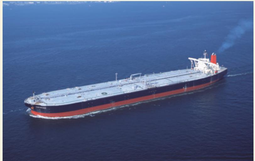
原油を運ぶタンカーは20~30万トン級のVLCC(Very Large Crude Carrier)と呼ばれるタンカーが中心となっています。タンカー内は、15から20の小タンクに仕切られていて、事故の際、全量の流出を防ぐようになっています。
